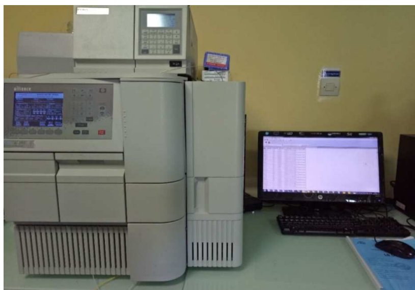
Figure 9 Système d'HPLC (Waters Alliance 2695)
