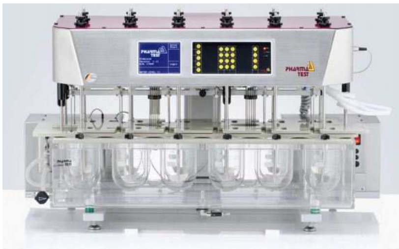
Figure 17 Appareil de dissolution in vitro (système à palettes)
